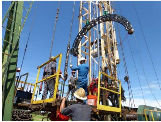
图 2 Paulsson 团队部署全光矢量地震和分布式光学传感器阵列现场图
