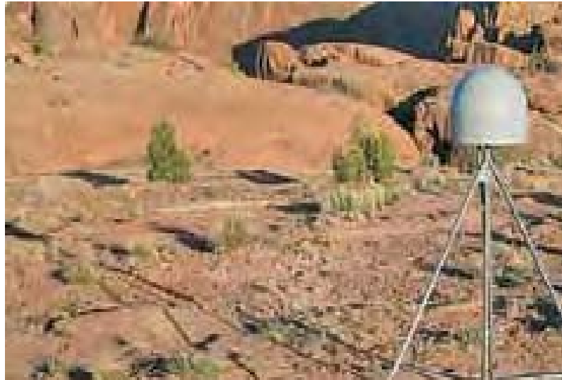
图 7 由新添加的 116 个 GPS 接受装置与原有的 20 个组成一个高速链接网络,提供整个板块边界地带长波,长周期的变化情况
